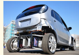
ワイヤレスインホイールモータを搭載した 実験車両FPEV4-Sawyer
