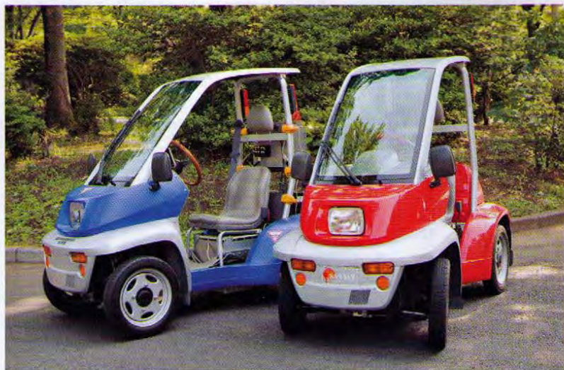
堀研究室で開発した電気自動車。スリップ防止制御、車体姿勢の四輪独立制御、路面状態推定などの研究を実施している
