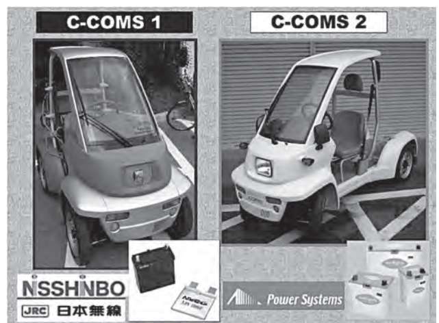
図1 キャパシタだけで走るC-COMS 1とC-COMS 2
